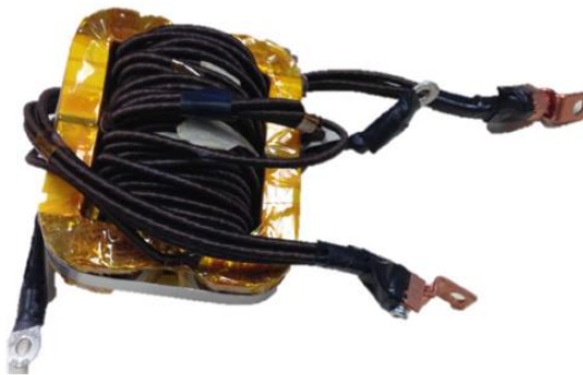
Figura 5. Transformador de 5 kVA, 25 kHz. [6]
