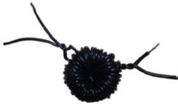
Figura 4. Transformador de 350 VA, 100 kHz. [6]
