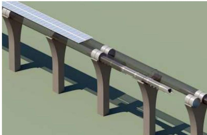
Figura 81. Alternativa para instalación de paneles sobre los tubos Hyperloop. [65]
