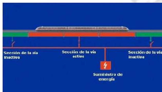
Figura 25. Esquema del diseño fraccionado de la vía.
