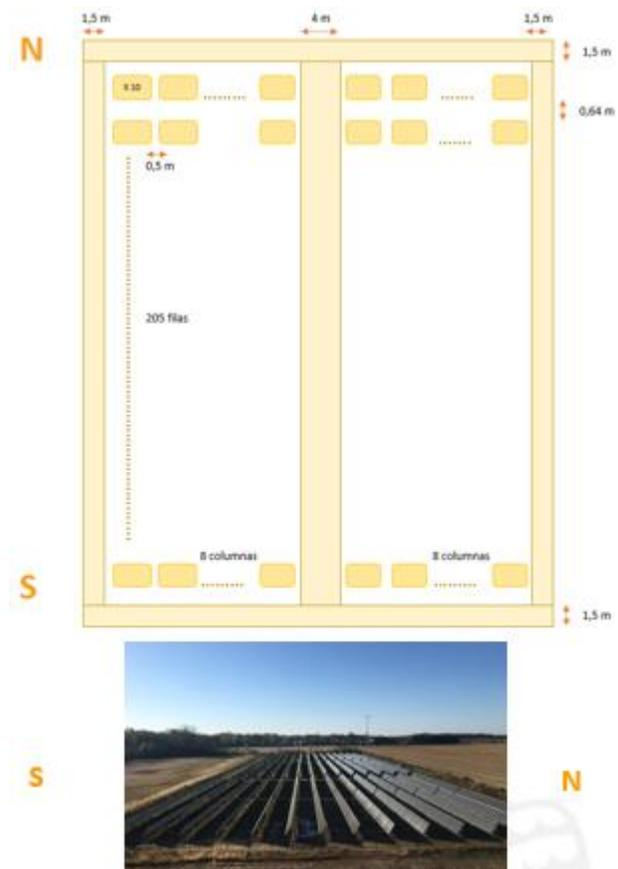
Figura 12. Distribución de los paneles vista en planta y perfil. Fuente: Elaboración propia.
