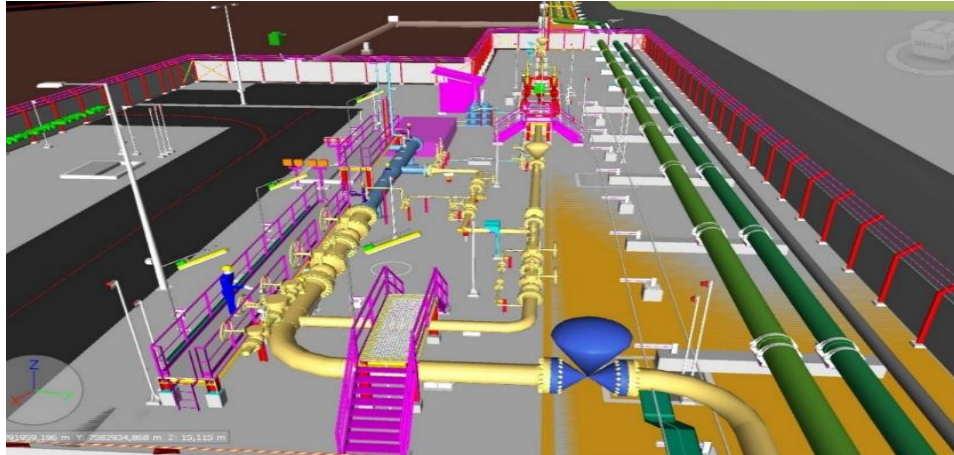
Figure 5- Estación de Regulación y Medida, Fuente [Diseño interno]
