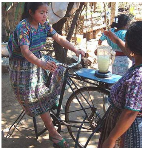
Figura 3.3. Bicilicuada (licuadora a base de pedaleo) fabricada por Maya Pedal
