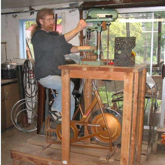
Figura 3.1. Herramienta de taladro accionada por pedaleo
