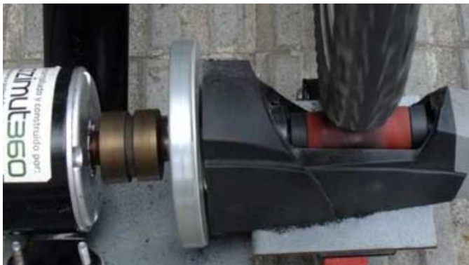
Figura 6.8. Colocación placa de apoyo del alternador con transmisión por rodillo
