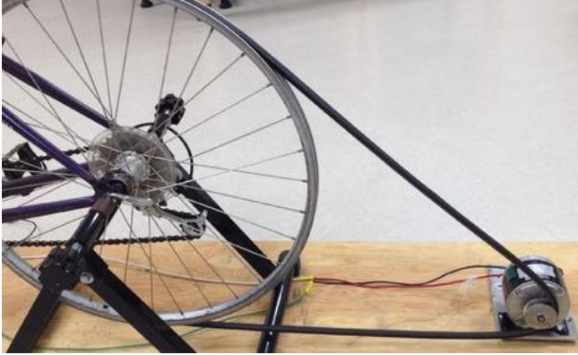
Figura 5.8. Transmisión por polea y correa
