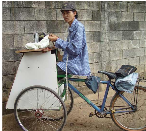
Figura 3.2. Máquina de coser montada sobre un triciclo en Yakarta
