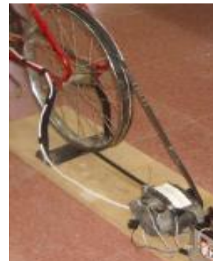
Figura 6.9. Colocación placa de apoyo del alternador con transmisión por polea
