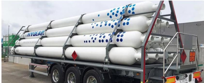
Figura 19. Tráiler de transporte de hidrógeno presurizado.
