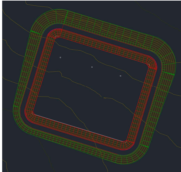
Figura 29: Ejemplo de localización de calicatas en interior de la balsa
