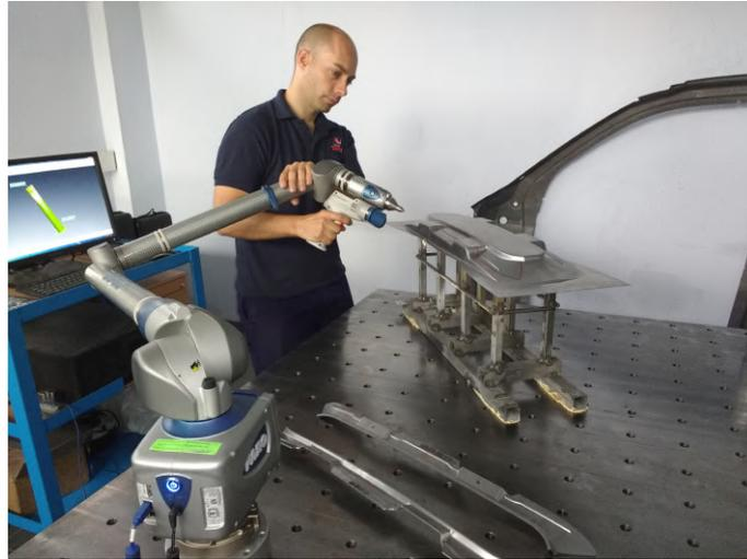
Figura 2.15: Escaneo por contacto. *Imagen cortesía de Faro*
