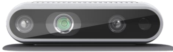
Figura 9. Cámara RGB-D. Intel RealSense D435 [28]
