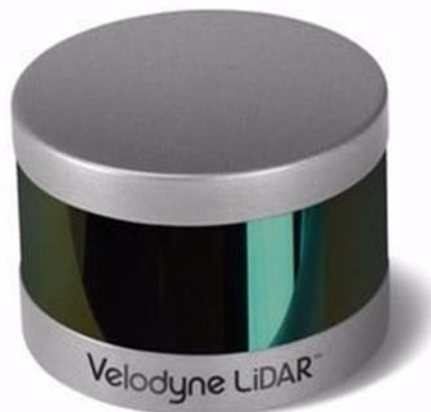
Figura 8. Sensor LIDAR de coche autónomo. Velodyne [27]
