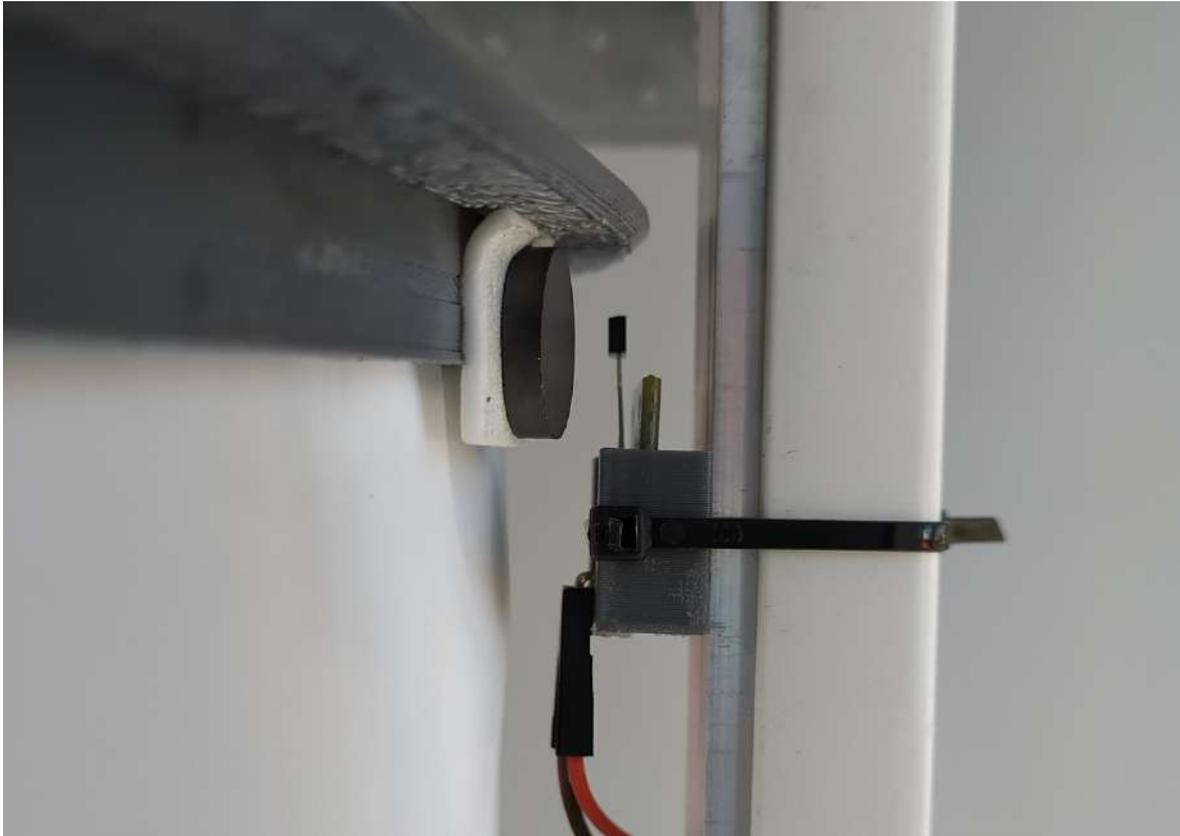
**Figura 16.** Sensor de efecto Hall o Holzer instalado en la turbina junto al imán de una pala
