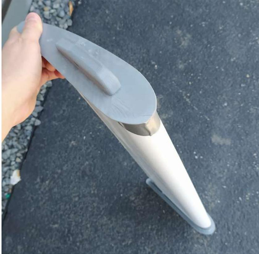
**Figura 21.** Pala de la turbina
