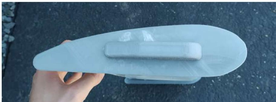
**Figura 20.** Perfil de ala de las palas de la turbina
