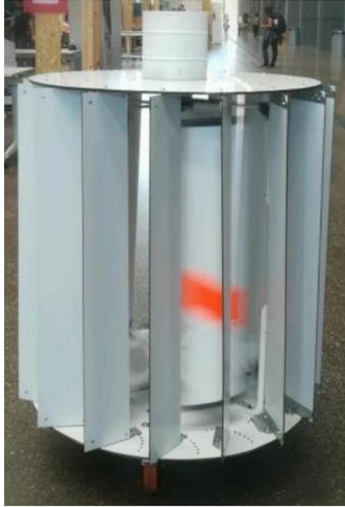
*Ilustración 1: Aerogenerador vertical diseñado por D. Juan Romeo.*
