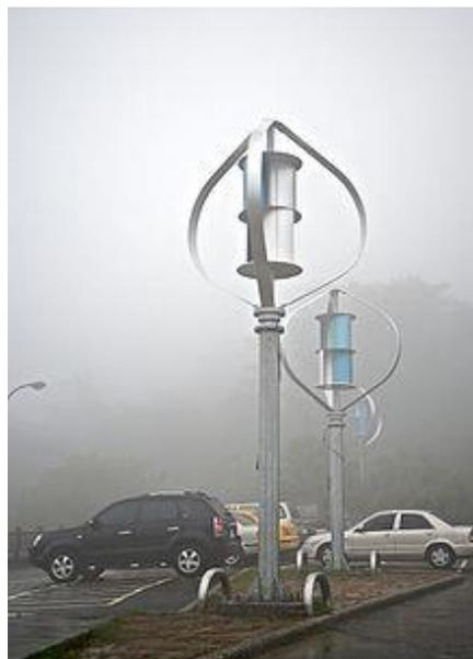
*Ilustración 18:Turbina Darrieus-Savonius, Taiwán [29].*
