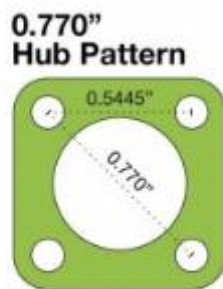
Fig.4b La presente figura muestra un plano del buje. Las dimensiones mostradas en pulgadas 0,77 y 0,5445 son en milímetros 1,9558 y 1,383 respectivamente.
