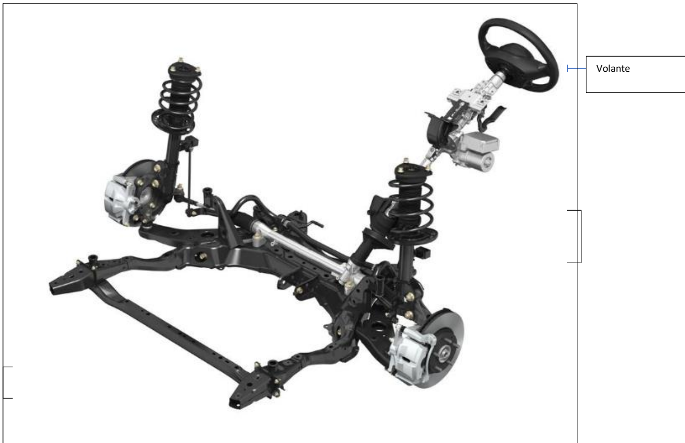
Fig 3a. Imagen obtenida de Red Operativa de Desguaces españoles. https://www.ro-des.com/mecanica/sistema-de-direccion-que-es/ . La figura muestra una imagen de un sistema de dirección sobre la que se han marcado algunos de los componentes más importantes.
