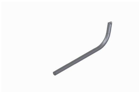
*Figura 2.3.2 – Diseño final de la Base transversal del bastidor (Elaboración propia)*
