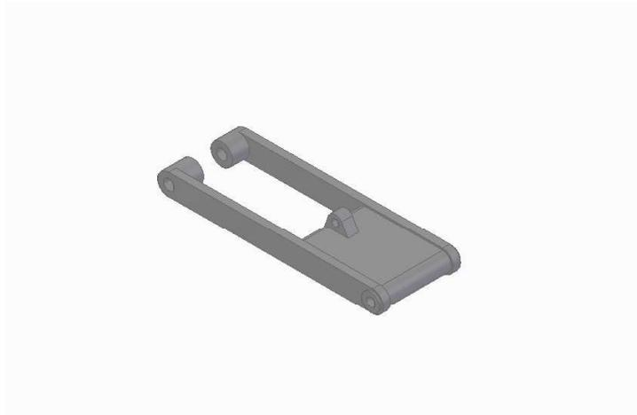
*Figura 2.4.1 – Propuesta 3D del Basculante (Elaboración propia)*
