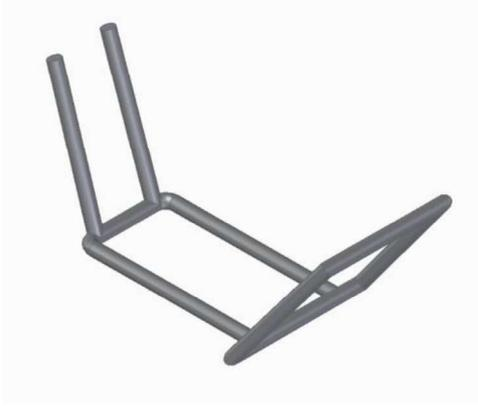
*Figura 1.2.3 – Vista isométrica del chasis de la motocicleta (Elaboración propia)*
