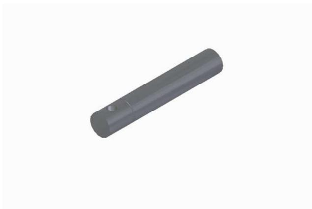
*Figura 2.3.10 – Diseño final del Eje superior del basculante (Elaboración propia)*
