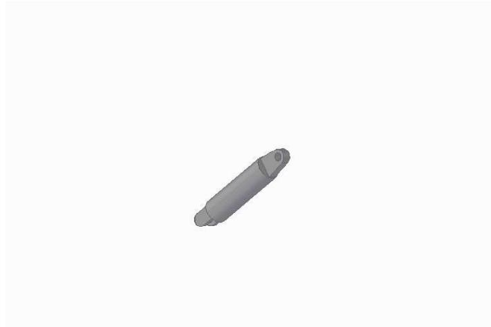
*Figura 2.4.4 – Propuesta 3D del Amortiguador (Elaboración propia)*
