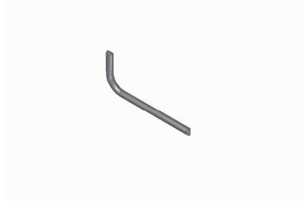
*Figura 2.3.3 – Diseño final de la Base longitudinal trasera del bastidor (Elaboración propia)*
