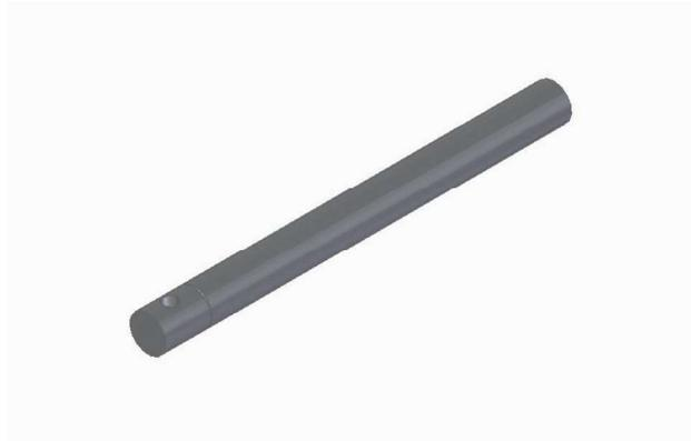
*Figura 2.3.9 – Diseño final del Eje inferior del basculante (Elaboración propia)*
