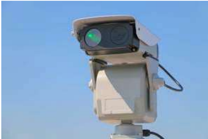
Ilustración 41: Sistema láser de disuasión de aves. Fuente: TransGuard
