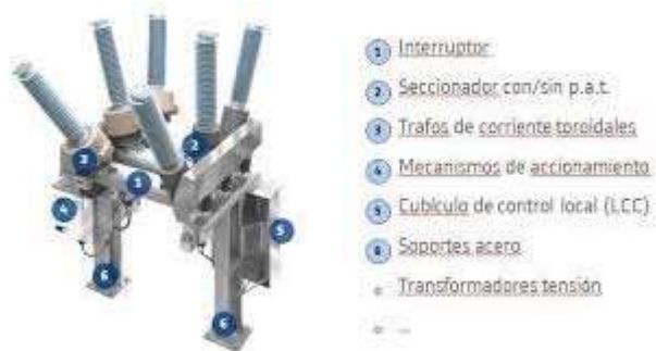
Ilustración 14: Esquema de interruptor de tanque muerto, donde se observa un trazo de corriente toroidal. Fuente: Universidad Carlos III
