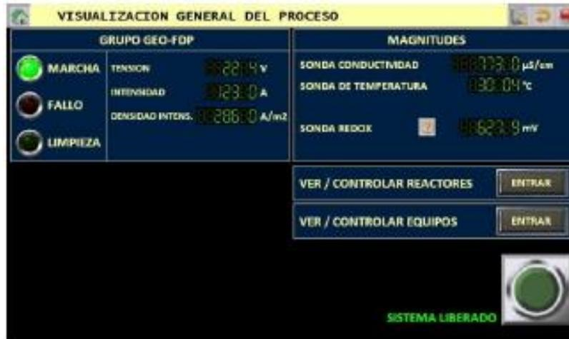
*Ilustración 7: Ejemplo de la pantalla principal de un HMI de un reactor proporcionado por Geodesic Innovations.*
