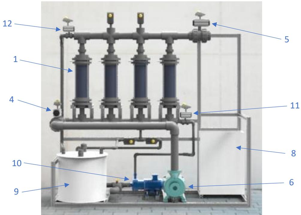
Ilustración 5: Equipo de 4 reactores/celdas proporcionado por Geodesic Innovations.
