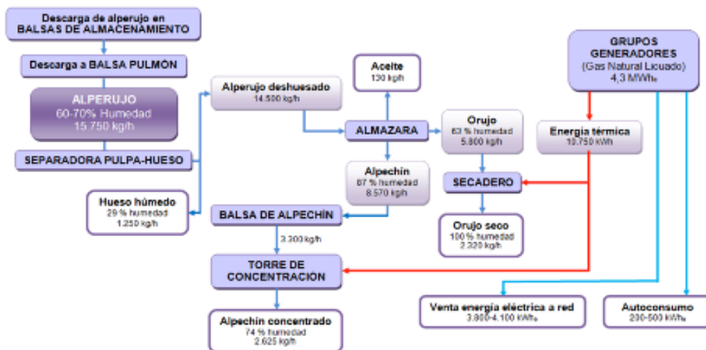
Ilustración 8: Proceso de tratamiento del alperujo
