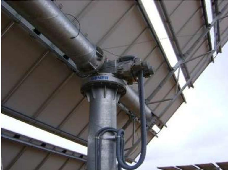
*Ilustración 13: Seguidor con dos ejes. Fuente: Efikosnews*
