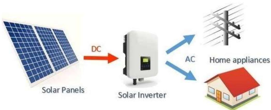
*Ilustración 14: Inversor CC/CA. Fuente: ER Solar*
