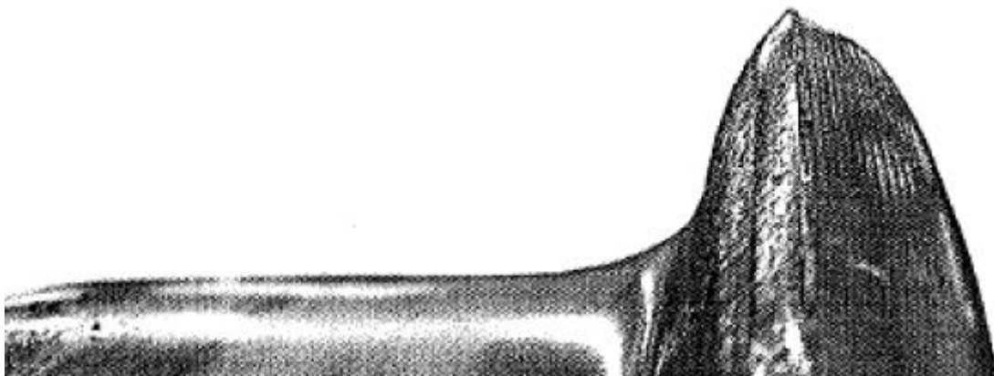
Ilustración 9 Ejemplo de desgaste de la pestaña.
