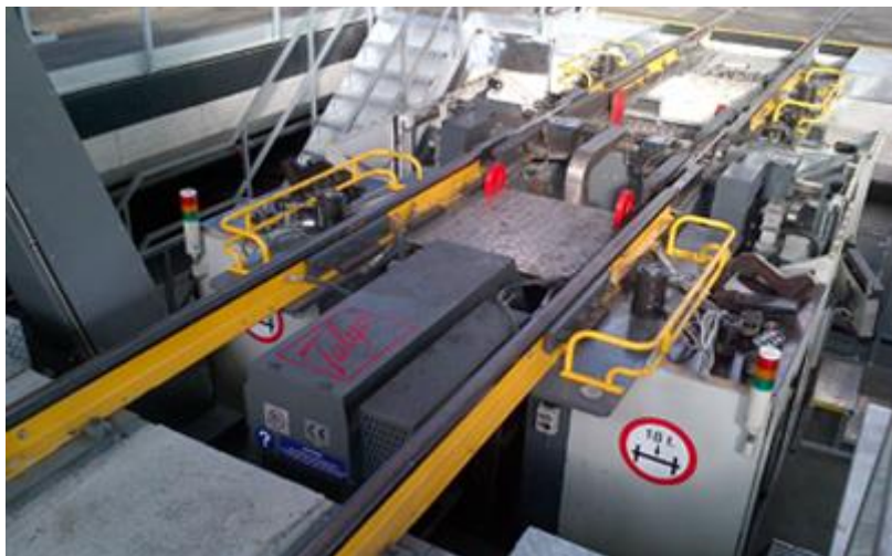
Ilustración 20 Torno de foso modelo 2112 de Talgo.
