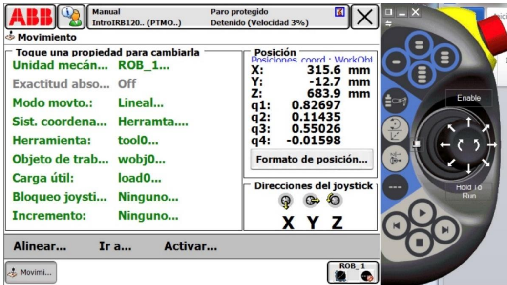
Figura 32: Interfaz del flexpendant para la obtención de coordenadas del robot
