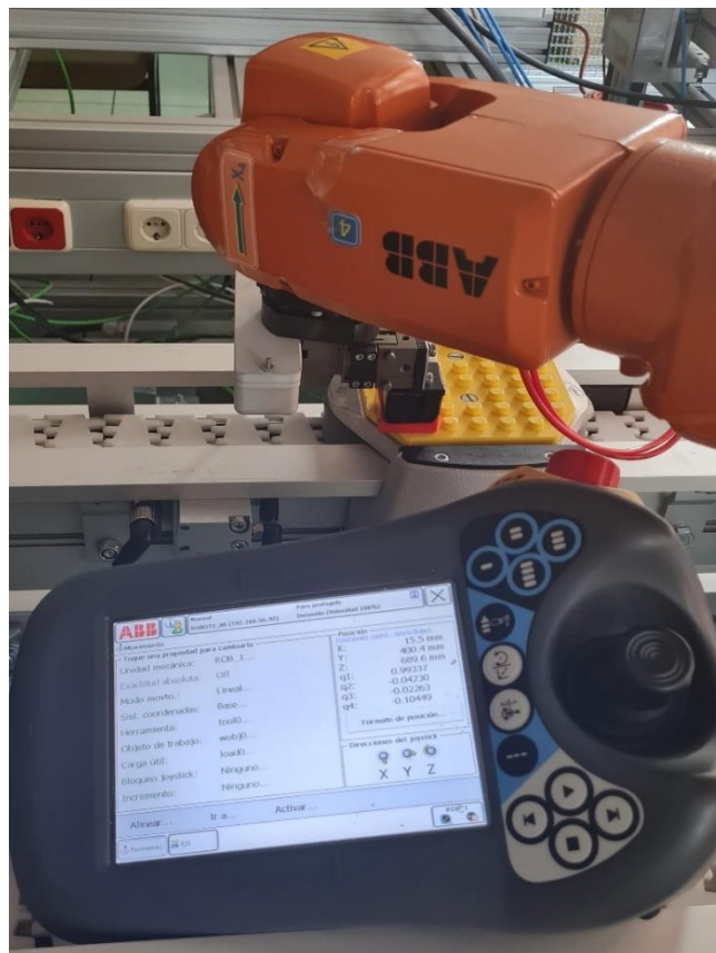
Figura 33: Extracción de coordenadas de la pieza en el sistema del robot empleando el flexpendant
