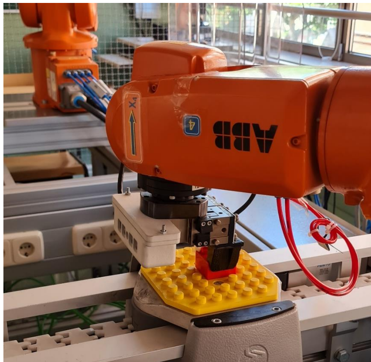
Figura 47: Recogida de la pieza tras análisis de la imagen
