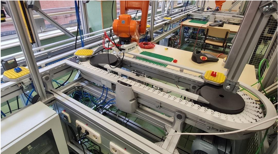
Figura 66: Incorporación de palé bloqueado a la cinta principal
