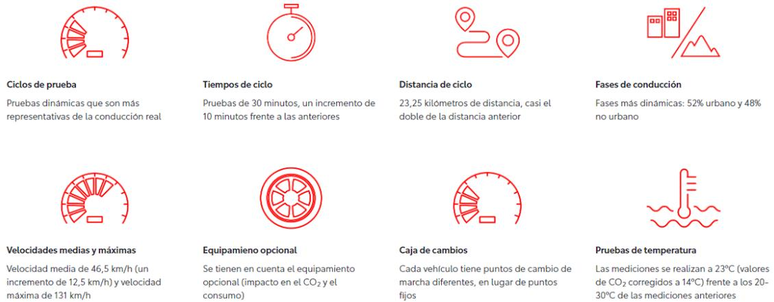
Figura 18. Principales cambios de NEDC a WLTP. Fuente [Toyota]
