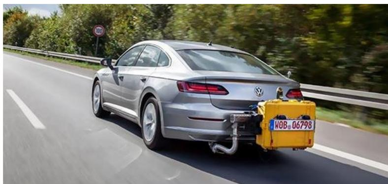
Figura 21. Dispositivos PEMS para las mediciones reales de emisiones.
