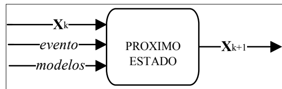
Figura 3.12. Transición de estado discreto
