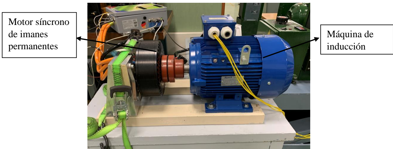
Figura 18:disposición de motor síncrono de imanes permanentes unido en el eje con la MI ALREN
