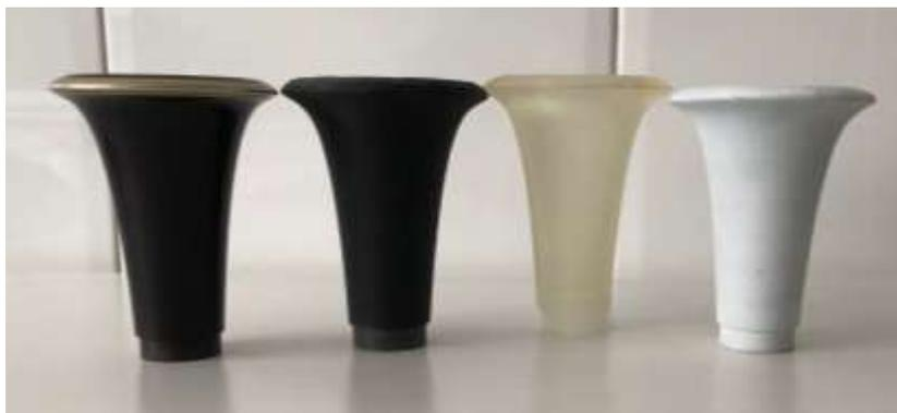
*Ilustración 2. Campanas original y prototipadas*
