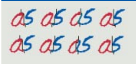
Figura 6. Resultados de 8 algoritmos Drop-Fall en el caso de un '0' conectado a un '5'
