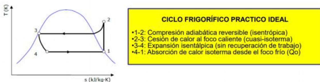
Figura 15. Ciclo frigorífico ideal. Fuente: ICAI - Climatización
