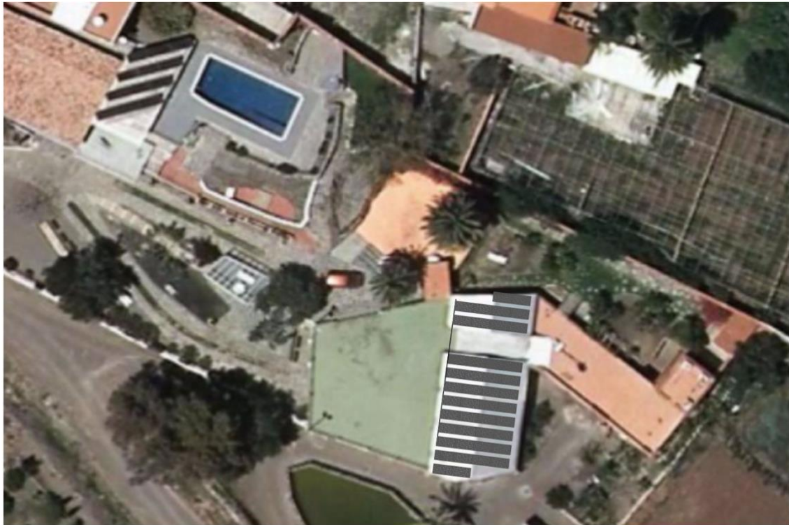
Figura 25. Disposición de los paneles solares en el proyecto. Orientación sur y en horizontal.
