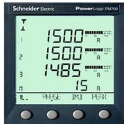
Figura 7. Analizador de red SCHNEIDER PowerLogic PM710.
