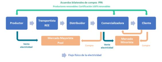
Figura 2: Esquema del sistema eléctrico español
