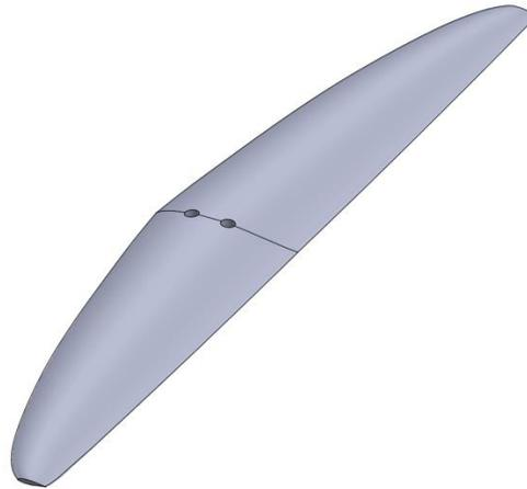
Imagen 50: Ala trasera del sistema de hidrofoil.
