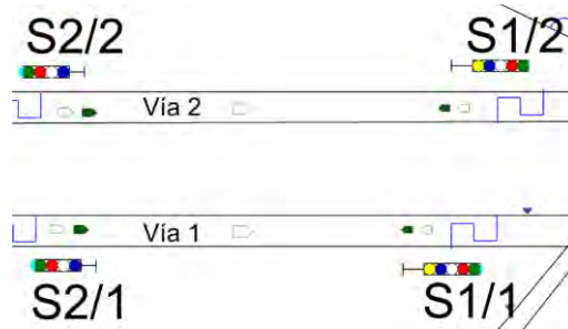
Figura 32. Señalización lateral salida de las vías
