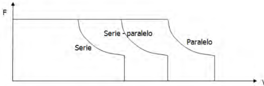
Figura 27. Curvas típicas de esfuerzo de tracción
