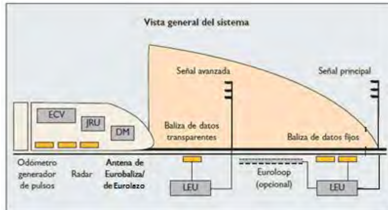
Figura 18. Esquema ETCS Nivel 1[LORE07]
