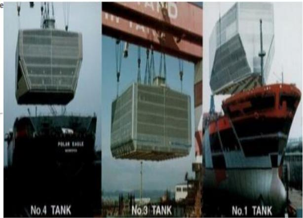
Tanques tipo A siendo instalados a bordo. Fuente:ingenieromarino.com
