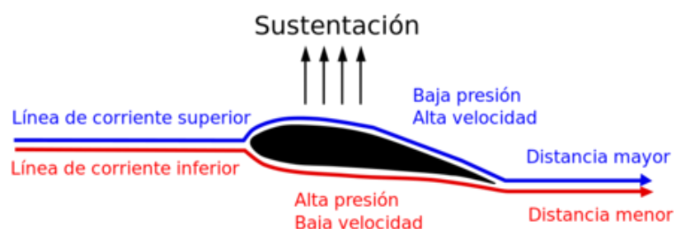
Ilustración 22: Fenómeno de sustentación (Fuente: [13])
