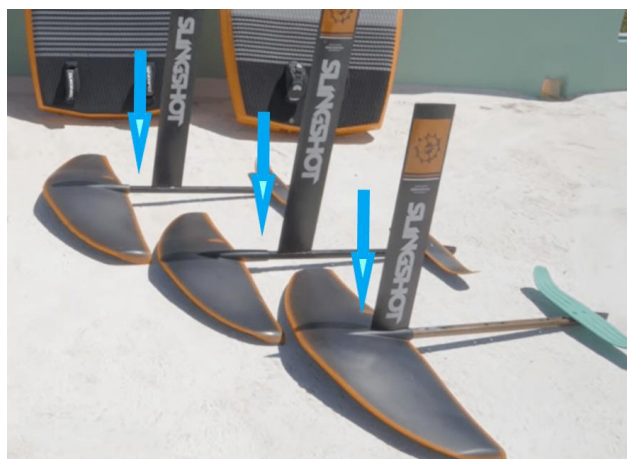
Ilustración 8: Comparativa de montaje del mástil sobre el fuselaje (Fuente: [3])
