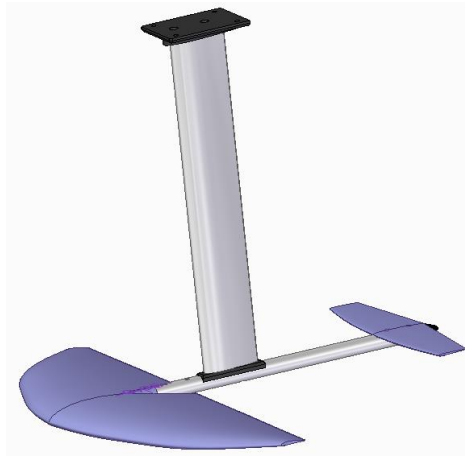
Ilustración 122: Conjunto final hydrofoil
