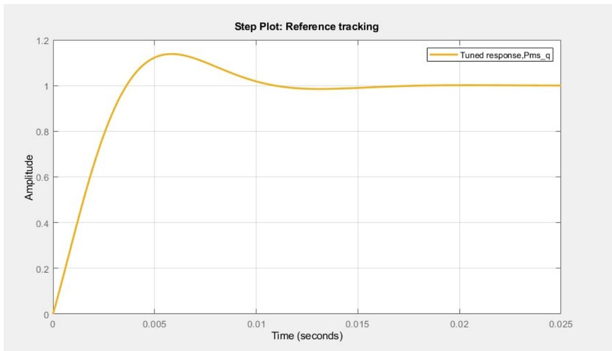
Figura 23: Respuesta ante escalón unitario de la planta en eje q.
