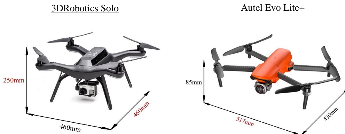
Ilustración 35: Dimensiones del 3DR Solo y Autel Evo Lite+. Fuente: elaboración propia con imágenes de www.3DR.com y www.Autel.com
