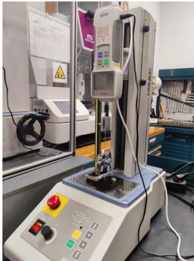
*Figura 37. Dinamómetro digital IMADA ZP-220N.*
