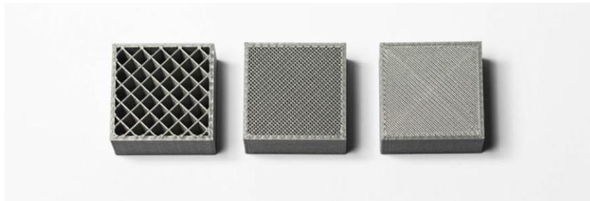
*Figura 22. Diferentes densidades de relleno en una impresión FDM.*
