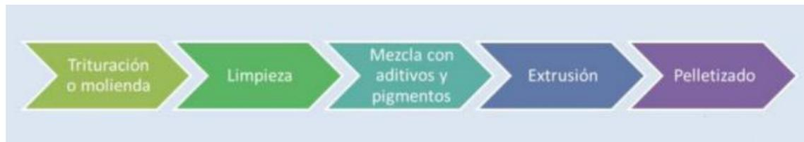
*Figura 7. Diagrama del reciclado mecánico.*
