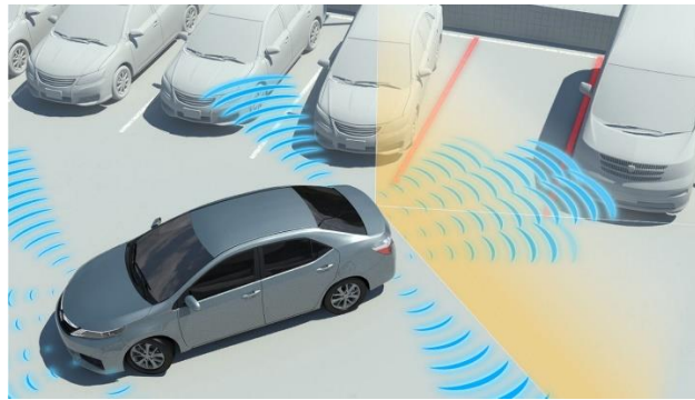
Ilustración 7. Emisión de ultrasonidos en un vehículo [8]
