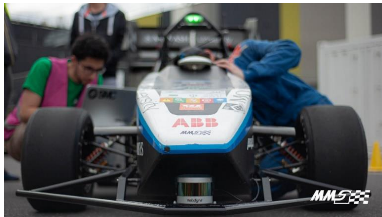
Ilustración 17. LiDAR Velodyne posicionado en el alerón frontal del monoplaza del equipo Monash Motorsport [15]
