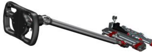
Ilustración 26. Sistema de dirección del monoplaza de AMZ Racing Team [21]
