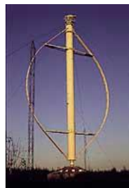
Figura 10: Aerogenerador vertical Darrieus. Fuente: [8]
