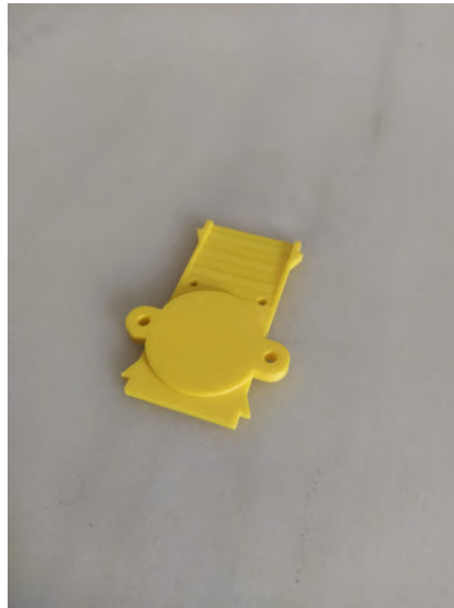
Figura 2.8: Placa auxiliar para sujetar la rueda de bola
