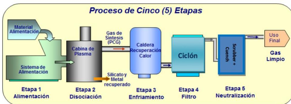
Este sistema se ha diseñado de la forma más eficiente posible, incluyendo un sistema de aprovechamiento de pérdidas caloríficas a través de un ciclo Rankine. Tras cada una de estas etapas se obtiene un gas sintético de alta concentración en hidrógeno -en torno al 50%- el cual es apto para su uso como combustible. Para el diseño de este proyecto en la ciudad elegida, se ha estimado un flujo constante de unos 35.000 kg de este gas a la hora, lo cual corresponde a unos 3.000 kg de hidrógeno.
