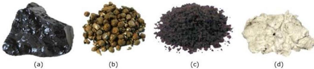
Figura 3.21: (a) Vitrificado enfriado al aire libre. (b) Nódulos de metal. (c) Vitrificado con agua. (d) Vitrificado lana mineral.
