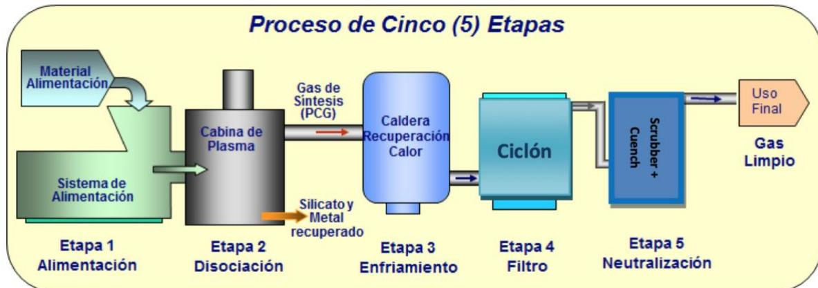
Imagen 10: Etapas del sistema de gasificación por plasma [8]
