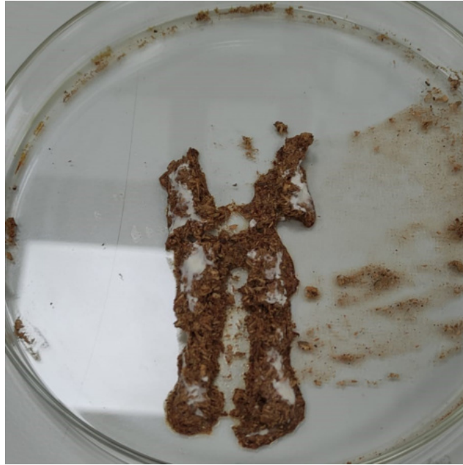
Figura 4.4: Probeta utilizada para controlar el desarrollo del micelio por el sustrato.
