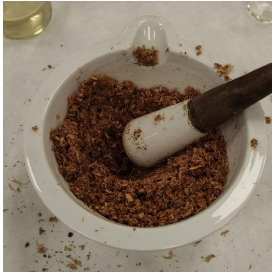
Figura 3.7: Sustrato en el proceso de ser molido y mezclado.
