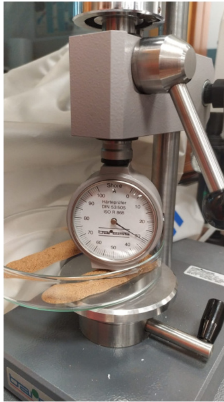
Figura 3.16: Ensayo de dureza para una pieza creada con el material.
