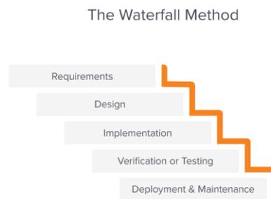
*Figura 27. Esquema de un modelo en cascada [7]*
