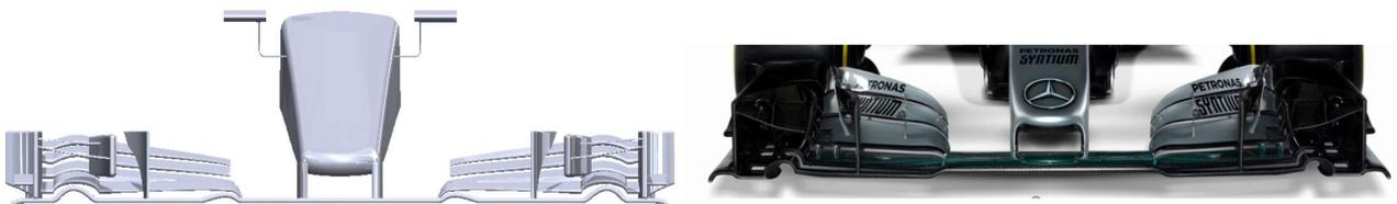
*Figure 41: W07 Frontwing CAD vs Real*
