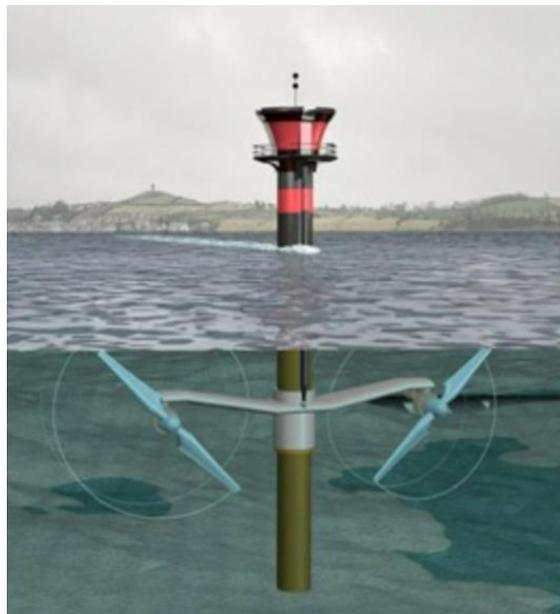
Ilustración 4: Generador Mareomotriz de Corriente de marea [3].
