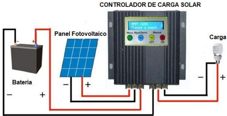
Ilustración 17: Conexión de un regulador a un sistema fotovoltaico. Fuente www.bateriasdelitio.net
