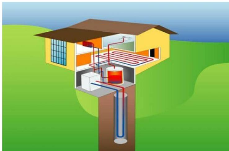
*Ilustración 4. Geotermia en vivienda unifamiliar.* <https://arquitectura-sostenible.es/la-geotermia-para-las-viviendas-unifamiliares-como-solucion-idonea-de-futuro/#:~:text=La%20Geotermia%20para%20las%20viviendas%20unifamiliares%20como%20soluci%C3%B3n%20id%C3%B3nea%20>
