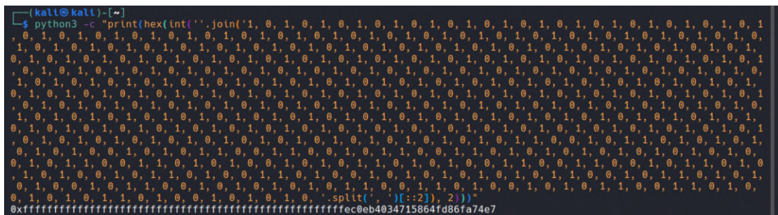
Fig. B.16. Tratamiento de una secuencia de bits con codificación Manchester
