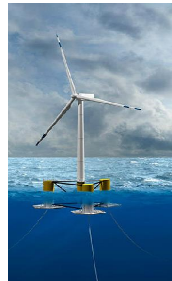
Ilustración 25.- Plataforma Semi-sumergible. Fuente: Iraeta energy equipment
