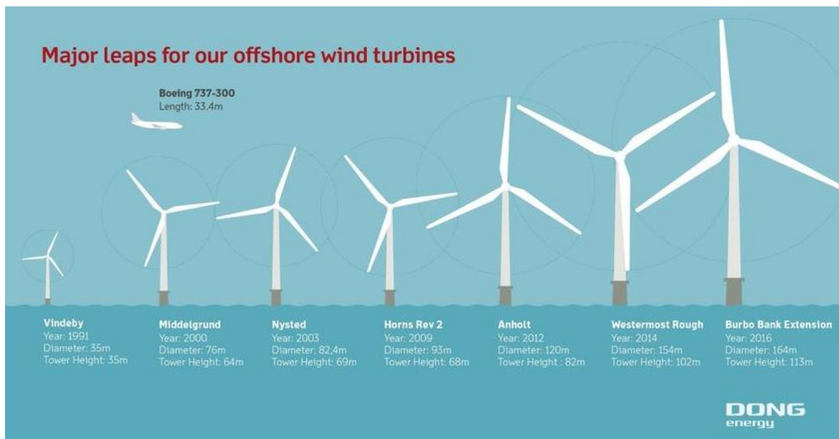
Ilustración 4.- Evolución de los parques eólicos offshore. Fuente: Dong Energy
