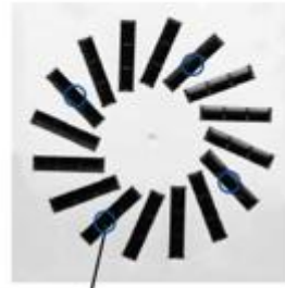
En el medio del deflector se efectuará de 4-6 puntos de medición por difusor dependiendo del tamaño.
