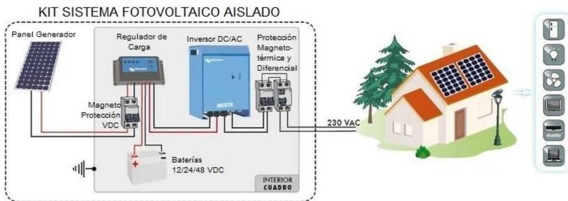
Figura 10: Esquema de una instalación fotovoltaica (Ingemecanica)
