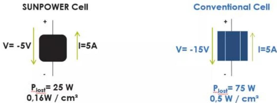
Figura 12:Funcionamiento de las celdas de SunPower en comparación con las convencionales (SunPower)
