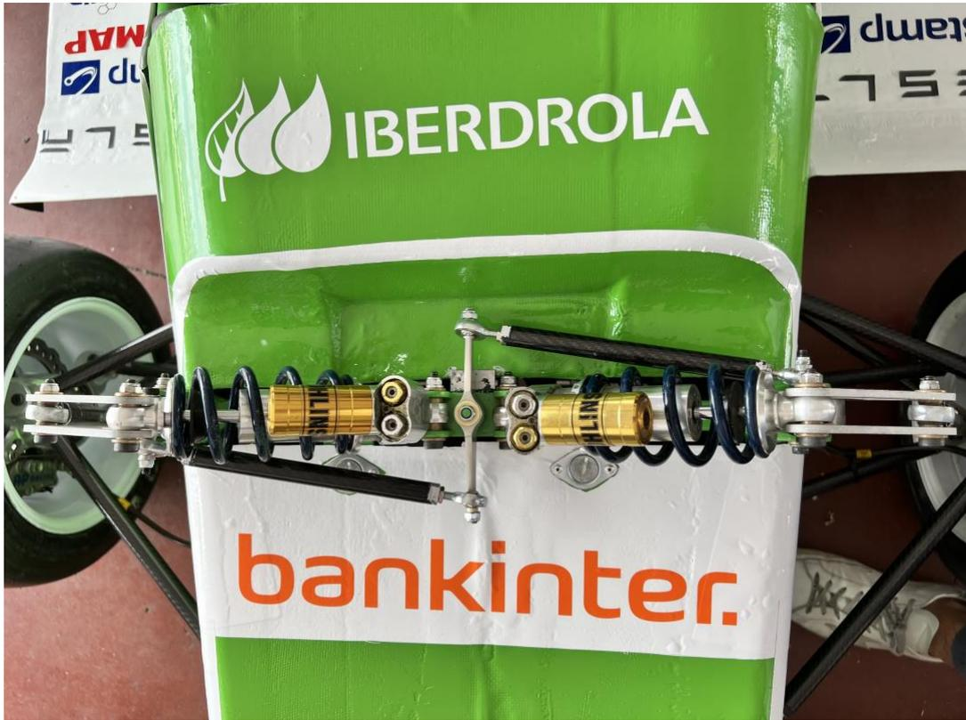
Figura 30. Sistema de barras estabilizadoras delantero
