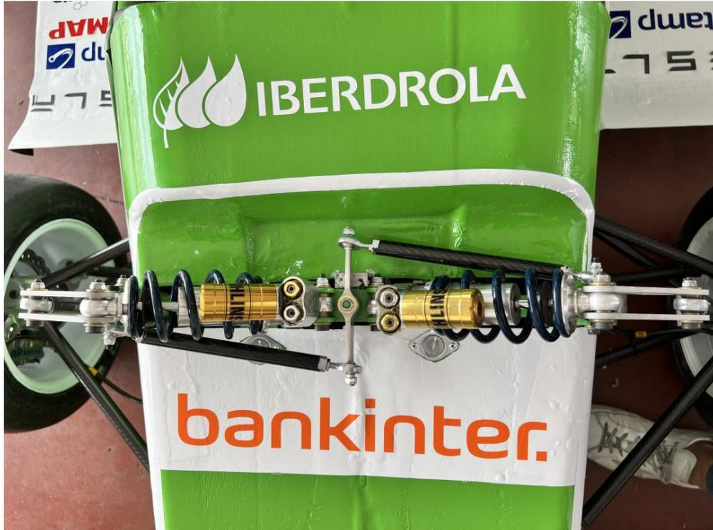
Este es el sistema en Z del eje delantero y, a continuación, el sistema en U del eje trasero:
