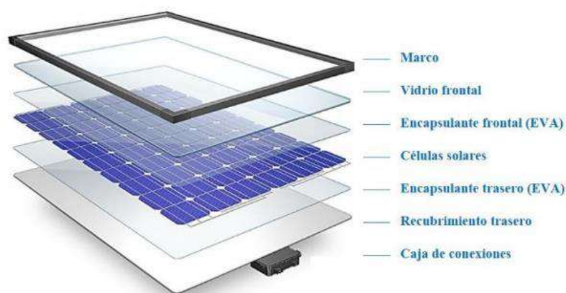
Figura 29. Esquema componentes de un módulo fotovoltaico
