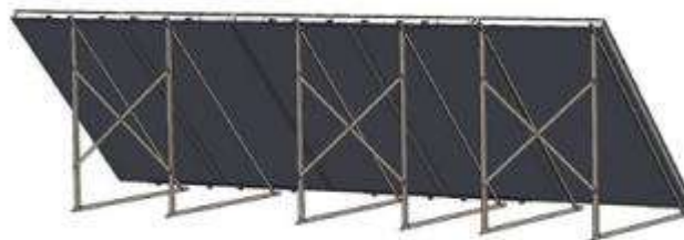
Figura 38. Esquema de batería de 5 captadores
